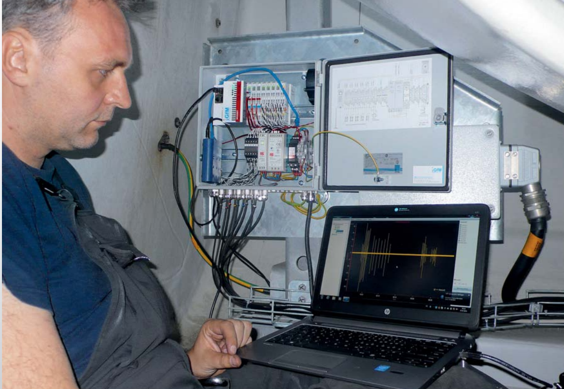
GfM-Mitarbeiter beim Test der am Peakanalyser angeschlossenen Beschleunigungssensoren
