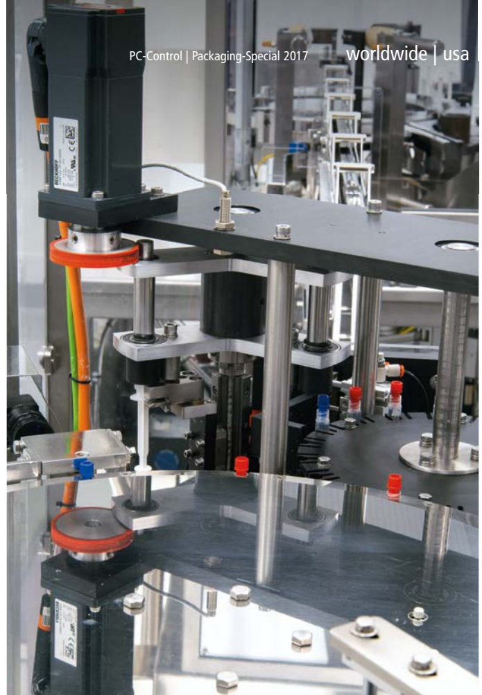
Die Servomotoren der Baureihen AM30xx und AM81xx bieten eine robuste und hochgenaue Bewegungssteuerung.
