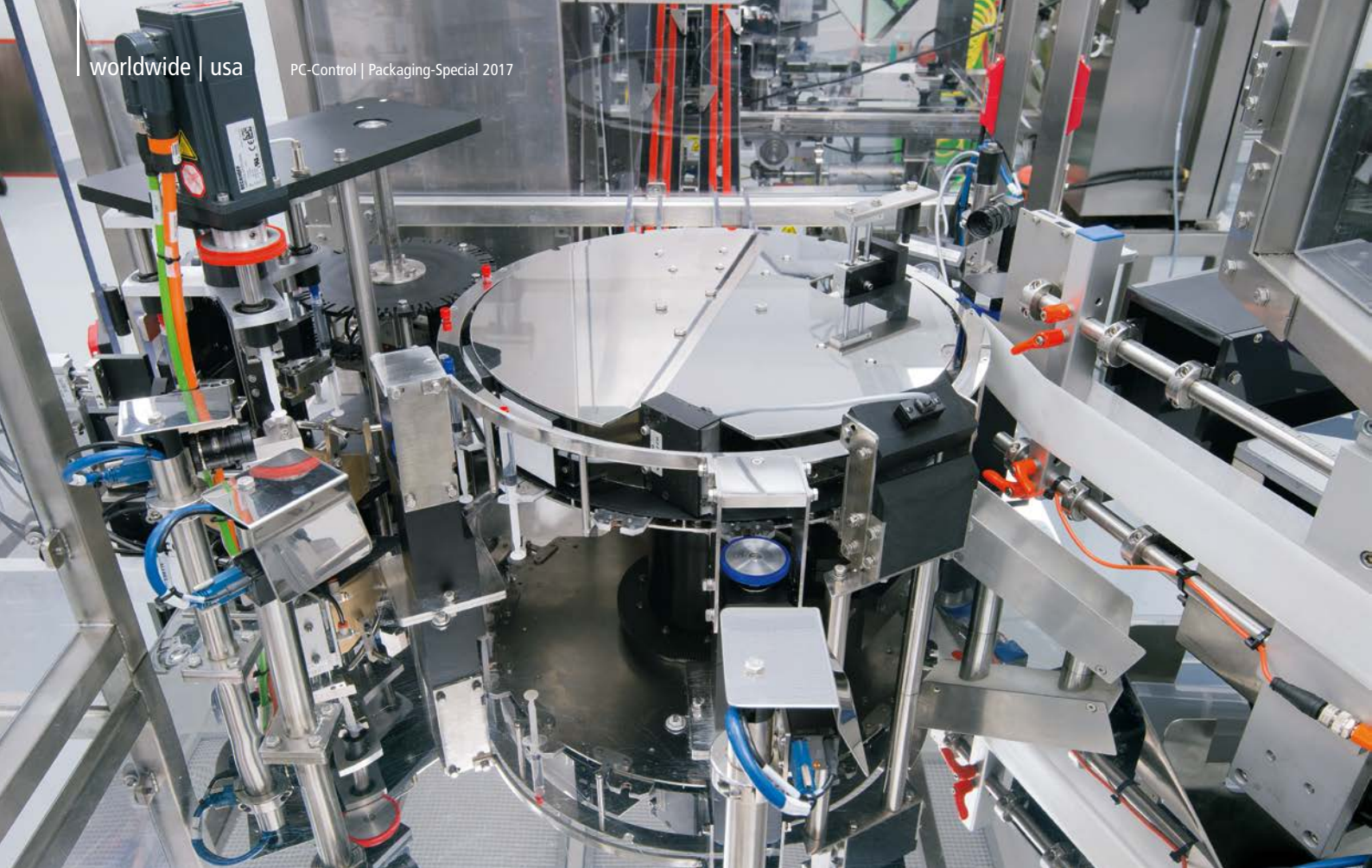
Die Inspektionsmaschine SASI-30 führt Spritzen oder Ampullen an bis zu sieben Kamerastationen vorbei, um die hohen medizinischen Hygienestandards zu erfüllen.
