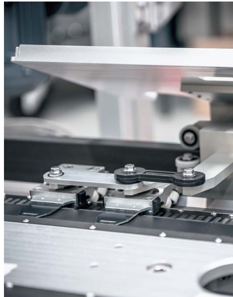
Graniten Engineering (s. Seite 22) hat jeweils zwei Mover miteinander verbunden, um hohe Nutzlasten dynamisch und präzise zu transportieren.
