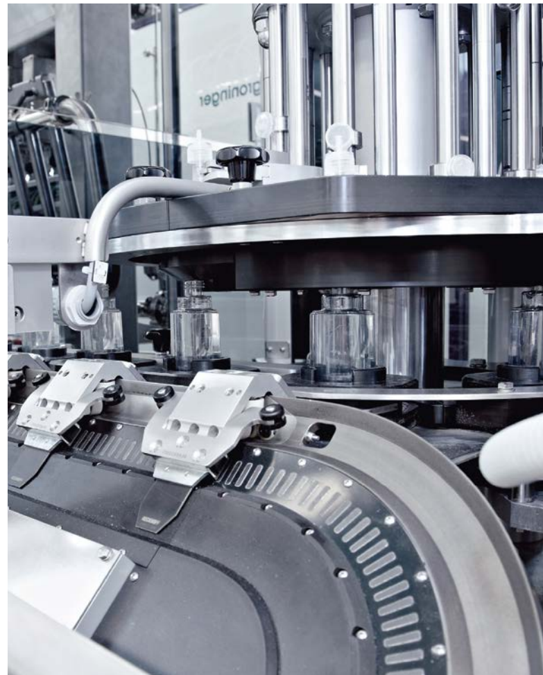
Besondere Innovationsfähigkeit beweist PC-based Control z. B. mit dem eXtended Transport System (XTS), das hier bei einer Kosmetikabfüllanlage von Groninger eine hohe Abfüllgeschwindigkeit mit einer extrem kompakten Maschinenbauweise vereint.
