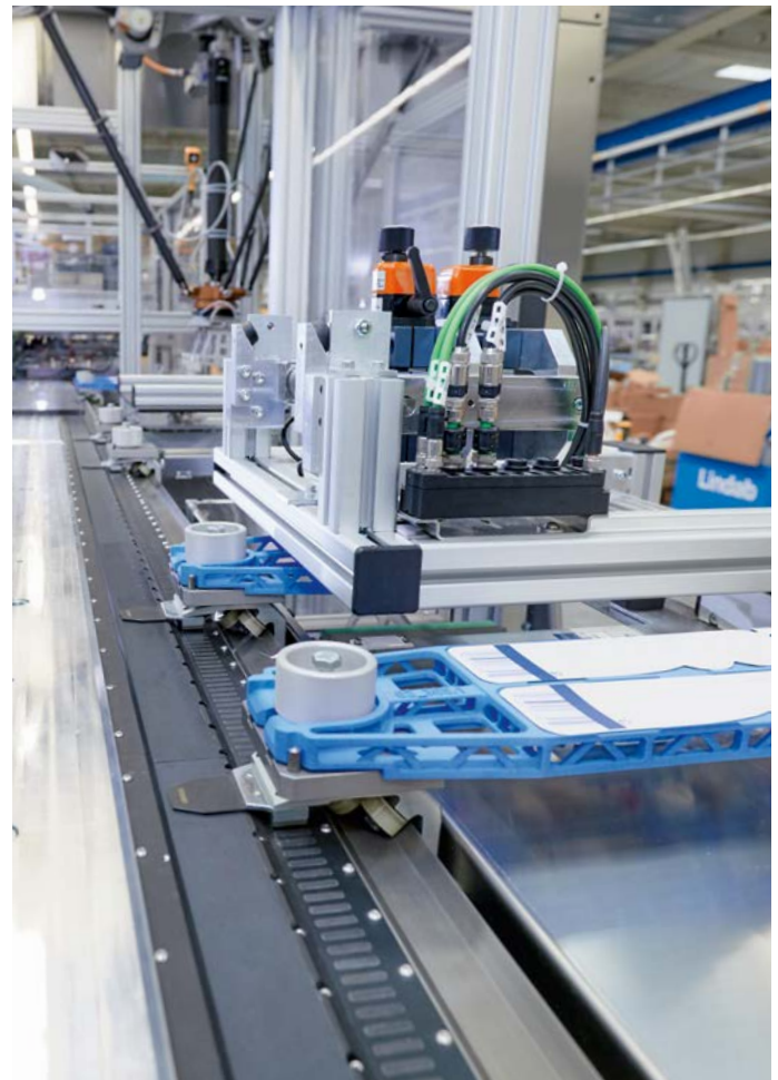
In der Zahnbürsten-Verpackungsanlage von Koch Pac-Systeme (s. Seite 14) ersetzt XTS aufwändige Mechanik durch Softwarefunktionalität und sorgt so für eine kompakte Bauform, hohe Flexibilität und extrem kurze Produktwechselzeiten.
