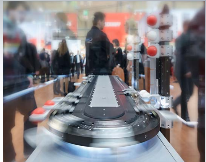
Abbildung 7: Die Kombination aus horizontalem XTS und vertikalen Systemen – hier als Demo auf der Hannover Messe 2014 – eignet sich optimal, um Elemente aus einem Produktstrom gezielt auszuschleusen und diesen dadurch nach den gewünschten Kriterien zu sortieren.
