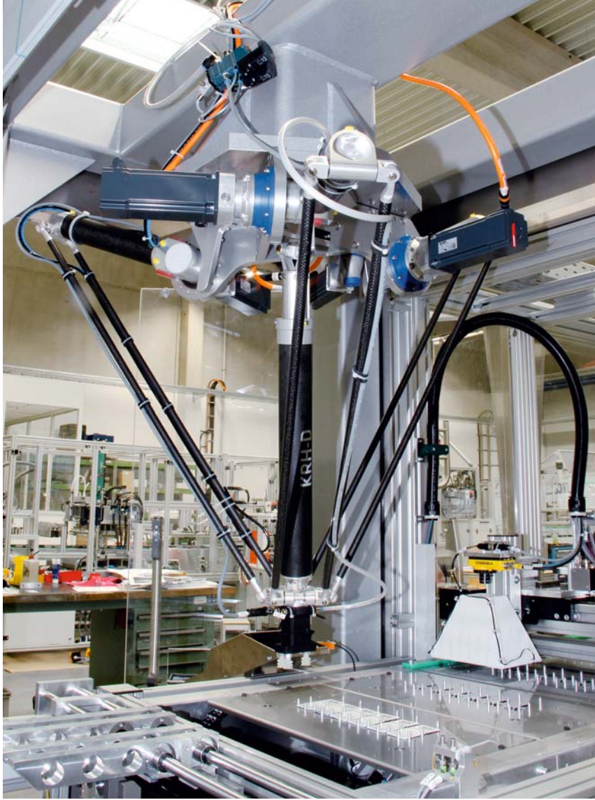
Der KOCH-Deltaroboter profitiert ebenfalls von der hohen Dynamik der AM8000-Servomotoren.
