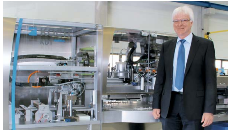
Jürgen Welker, KOCH-Bereichsleiter Automatisierung und Service, vor der neuen, für den Reinraumeinsatz in medizintechnischen Bereichen konzipierten Drehtischmaschine KDT medplus.
