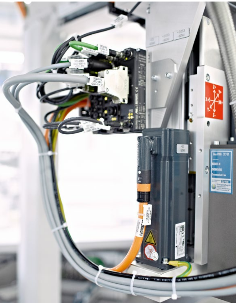
Die kompakten OCT-Servomotoren und die dezentral installierbaren EtherCAT-I/O-Module unterstützen einen besonders kompakten Maschinenaufbau.
