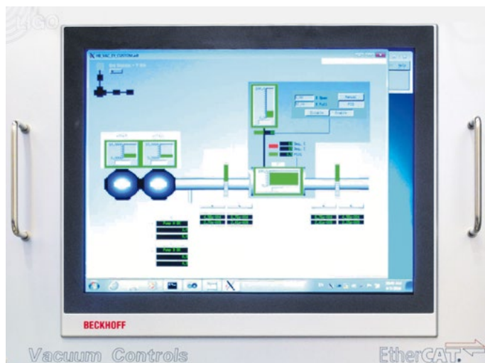
Das von LIGO entwickelte Vakuumsteuerungssystem setzt auf eine PC-basierte Steuerung und EtherCAT als Kommunikationstechnologie.
