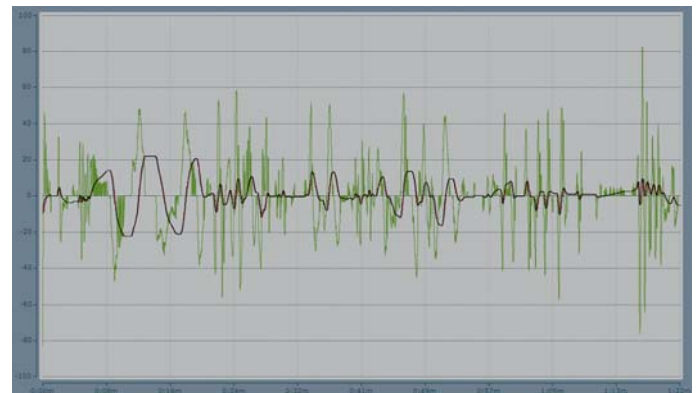
Schwarze Linie: verlangte Zielpunkte, Grüne Linie: Geschwindigkeitskurve, Rote Linie: Ist-Position
