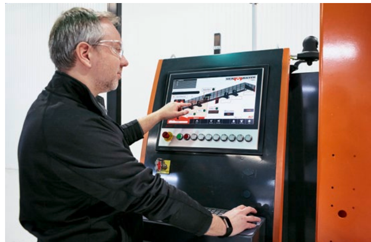
AGT Robotics implementierte als Bedieneroberfläche des Systems ein Multitouch-Control-Panel CP2918 von Beckhoff.
