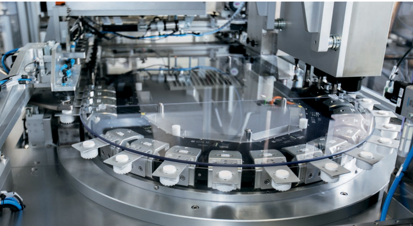
Die Goldfuß-Montagelinie für Verschlussdeckel profitiert von der hohen XTS-Softwarefunktionalität und ist daher äußerst kompakt aufgebaut und flexibel nutzbar.
