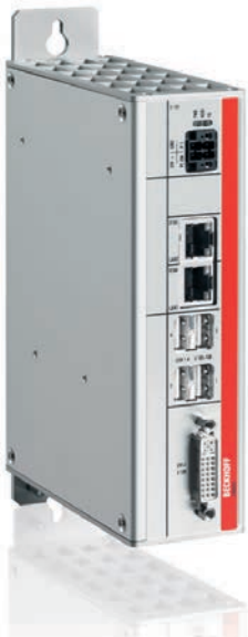
Der Industrie-PC C6905 ist für den Einbau in Schaltschränken konzipiert und ist mit einem 3½-Zoll-Motherboard mit Intel® Atom™ mit bis zu vier Cores ausgestattet.
