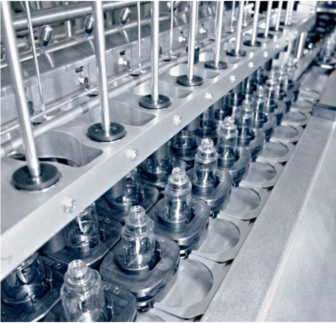
Jeweils zehn Flaschen werden mit Duftwasser gefüllt und dann mit ihren Werkstückträgern in die Greifelemente der wartenden XTS-Mover geschoben.
