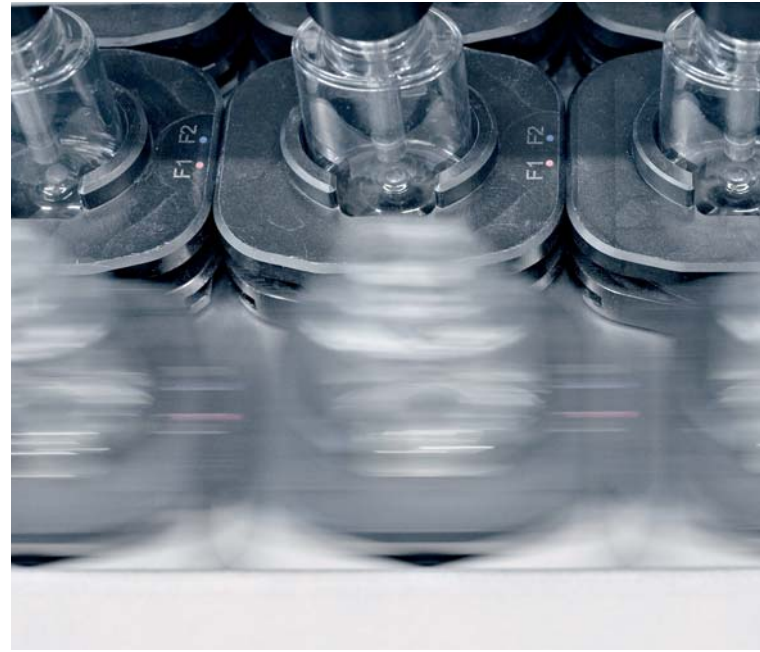
Die zehn Duftwasser-Flaschen werden nach dem Befüllen aus dem Stillstand beschleunigt und auf den kontinuierlichen Verschleißprozess aufsynchronisiert.
