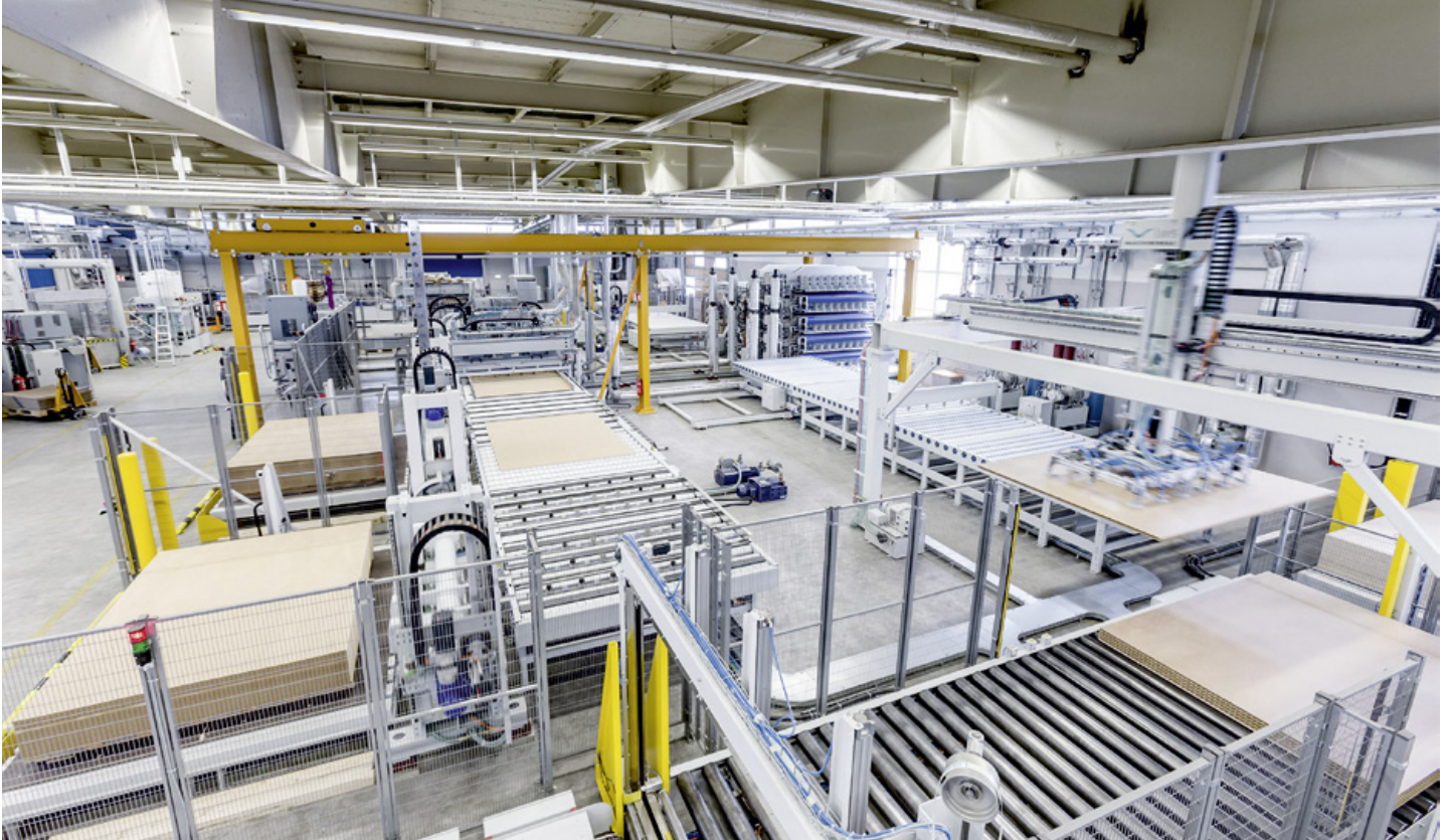
Die rechteckige Anordnung der Bearbeitungsstationen ergibt eine besonders kompakte und leistungsstarke Fertigungsanlage.
