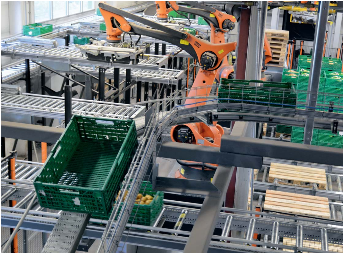
Palettierungsroboter holen die Leerpalletten ab und stapeln darauf die Beutel.
