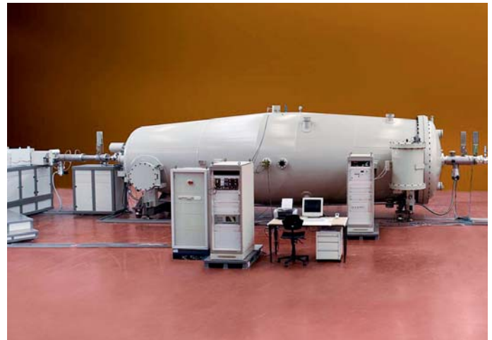
Metalltank eines 5-MV-Linearbeschleunigers, in dem sich das Beschleunigungsrohr befindet.
