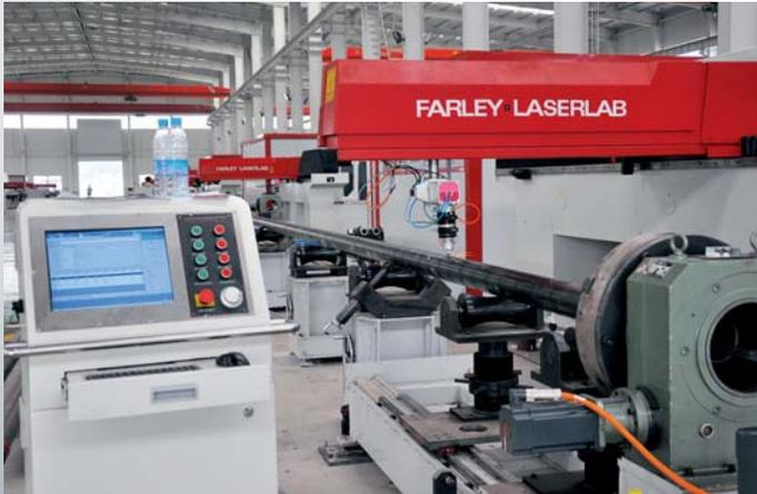
Im Bereich der Antriebstechnik sind die EtherCAT-Servoverstärker AX5000 und die Servomotoren der AM8000-Serie mit One Cable Technology im Einsatz.
