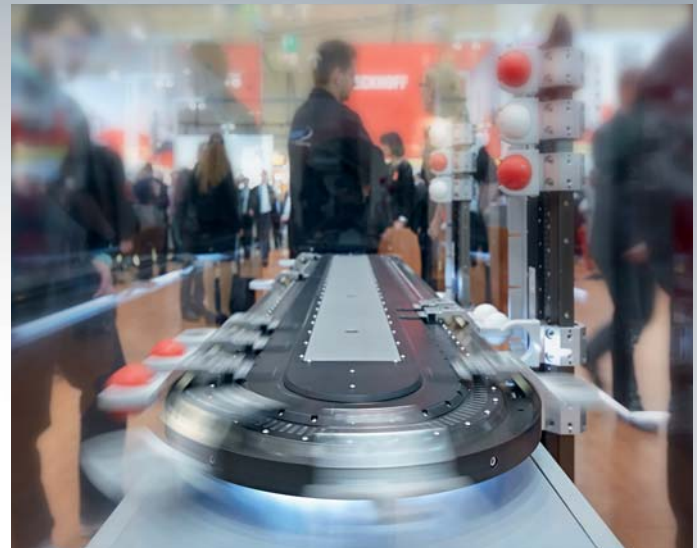
Abbildung 6: Die Kombination aus horizontalem XTS und vertikalen Systemen – hier als Demo auf der Hannover Messe 2014 – eignet sich optimal, um Elemente aus einem Produktstrom gezielt auszuschleusen und diesen dadurch nach den gewünschten Kriterien zu sortieren.
