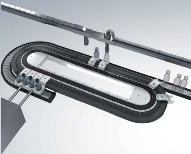
Abbildung 3: XTS eignet sich als Rundläufer insbesondere auch für Verarbeitungsprozesse wie die Flaschenabfüllung, bei denen ein kontinuierlicher Produktstrom diskontinuierlich zu bearbeiten ist.
