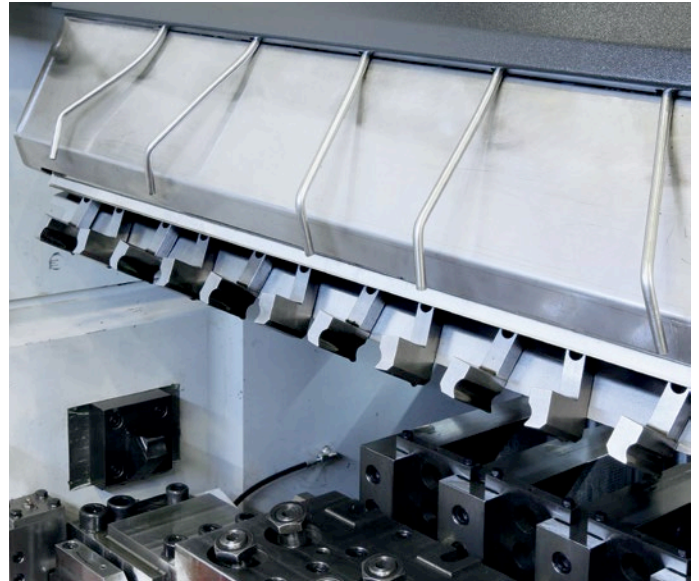
Die servogesteuerten Greiferfinger befördern die Produkte hochdynamisch und präzise zwischen den einzelnen Bearbeitungsschritten.
