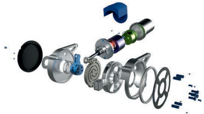
Durch die Montage einer Spiralfeder aus Titan zwischen der Skelettstruktur und dem Motor werden Stöße aufgefangen und das Drehmoment kann sehr präzise bestimmt werden.
