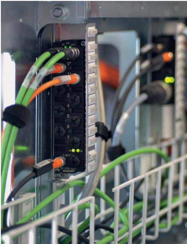
Mit Hilfe der digitalen EtherCAT Box EP1258 erfolgt die Identifizierung der Werkstückträger im Vorbeifahren. Bis zu 623 unterschiedliche Teileträger können am Transportsystem erfasst werden.
