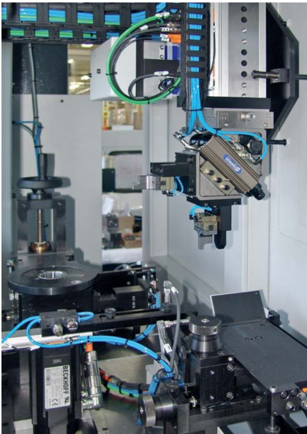
3-Achs-Handhabungsgerät der Schleifmaschine
