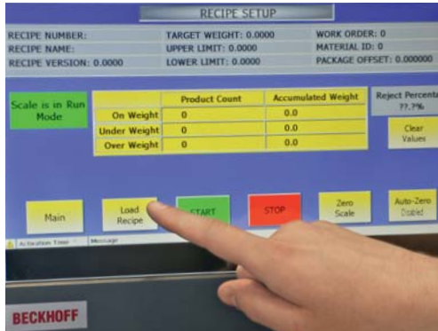
Die Visualisierung des Wägesystems erfolgt über ein Beckhoff Control Panel CP6902 mit 15-Zoll-Touchscreen.
