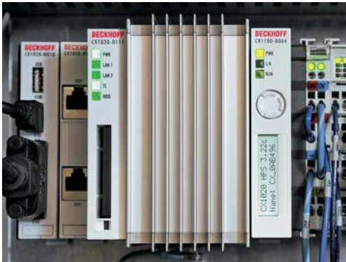
Als Steuerungsplattform der Kontrollwaagen verwendet Friesen's die Beckhoff Embedded-PCs CX1020 mit der Automatisierungssoftware TwinCAT PLC und EtherCAT-I/Os.
