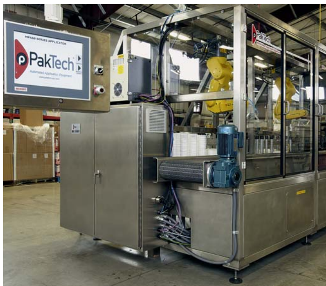
Paktech Handle-Applikator zum Aufbringen von Kunststofftragegriffen auf Mehrfachpackungen von PET-Flaschen und Kunststoffbehältern.
