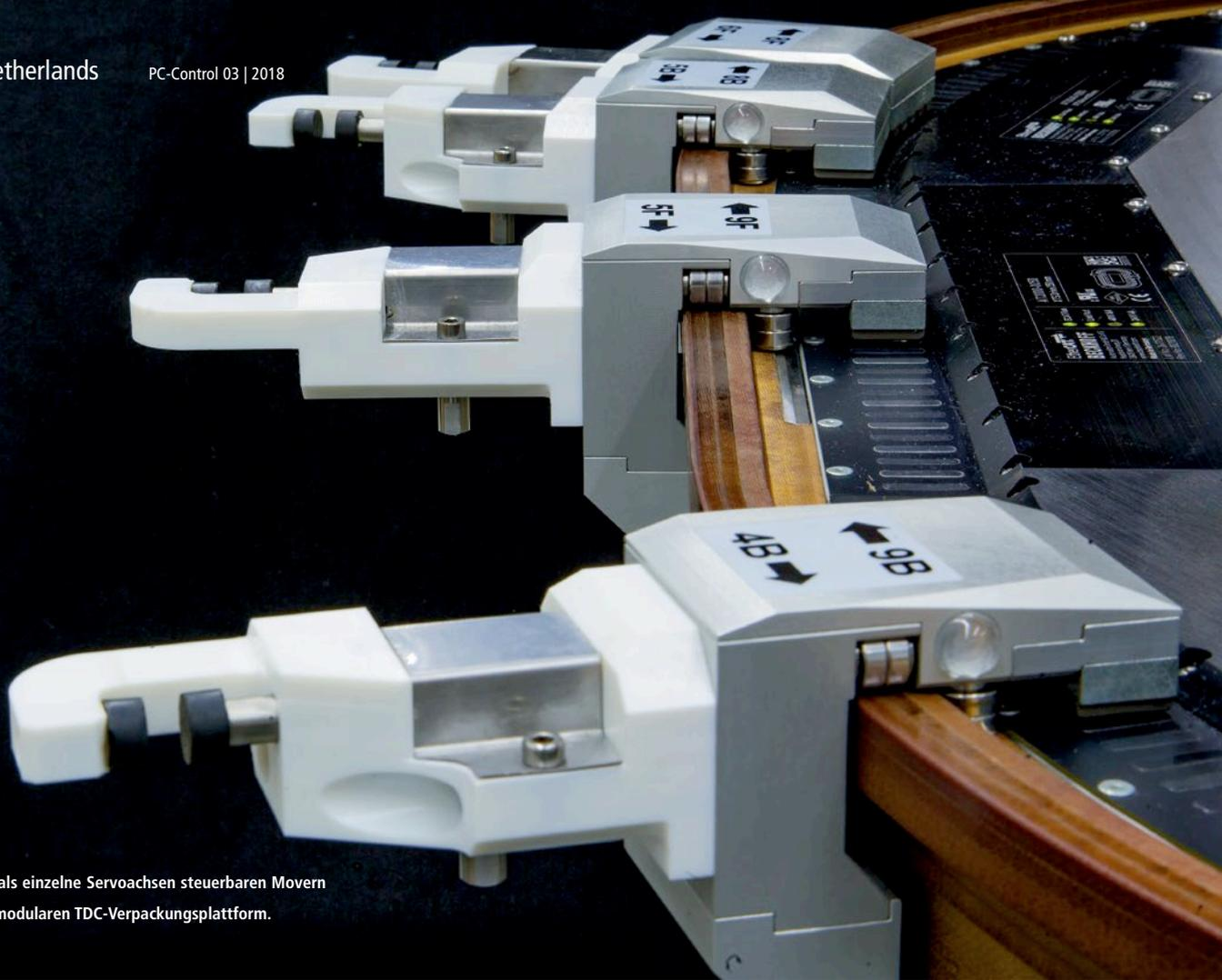
XTS bildet mit seinen als einzelne Servoachsen steuerbaren Movern das Kernelement der modularen TDC-Verpackungsplattform.
