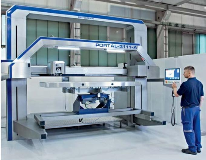
Die modulare Bandschleifmaschine Omni-Grind Portal ermöglicht in der höchsten Ausbaustufe einen vollautomatischen Schleifprozess.
