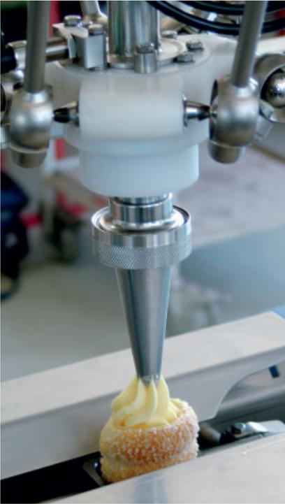
Die Cornets werden in Halterungen, die einen fixen Abstand und eine definierte Höhenabmessung haben, aufrecht der Befüllung zugeführt.
