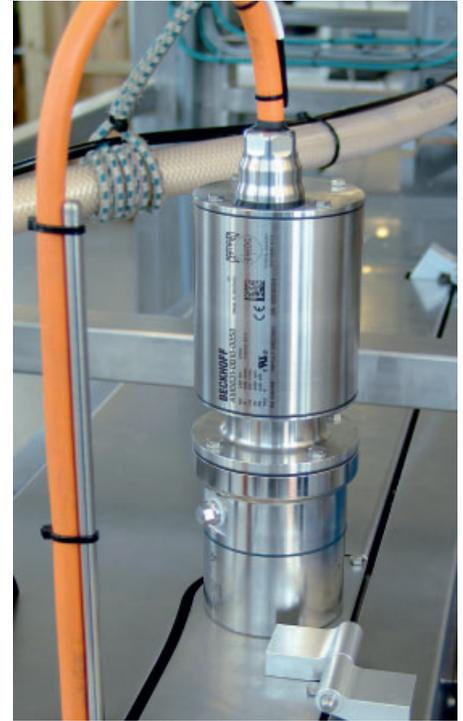
Zur Ansteuerung der Befüllanlage ist auch der Servomotor AM8831 im Edelstahlgehäuse mit EHEDG-Zertifizierung im Einsatz.
