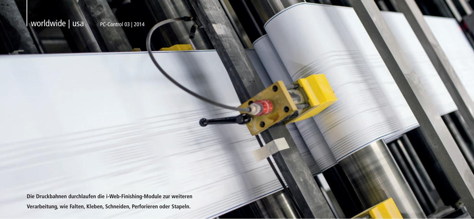
Die Druckbahnen durchlaufen die i-Web-Finishing-Module zur weiteren Verarbeitung, wie Falten, Kleben, Schneiden, Perforieren oder Stapeln.
