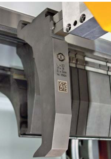
Ein Scanner erkennt die Werkzeuge und setzt sie mittels des Matrixcodes positionsgenau in die Wangen ein.
