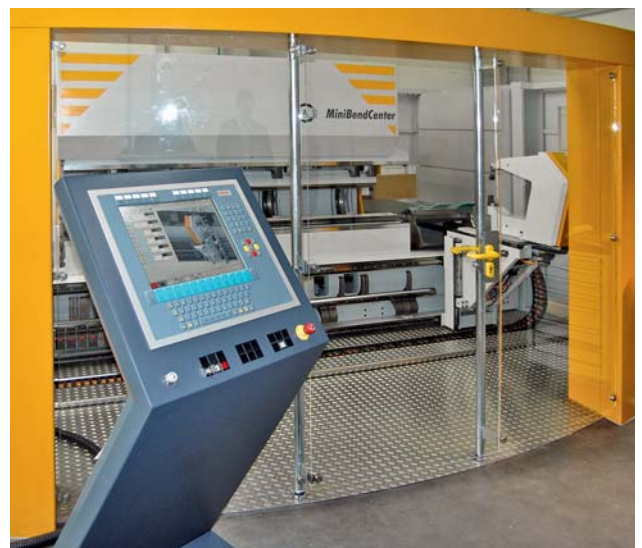
Vom Industrie-PC abgesetztes Control Panel als Bedien- und Visualisierungsplattform
