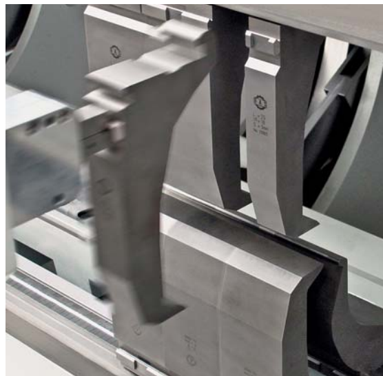
Bevor das Biegen beginnt, bestückt ein Werkzeugwechsler die einzelnen Biegestationen automatisch. Vom CAM-System erhält die Maschinensteuerung die benötigten Werkzeuglängen pro Station.
