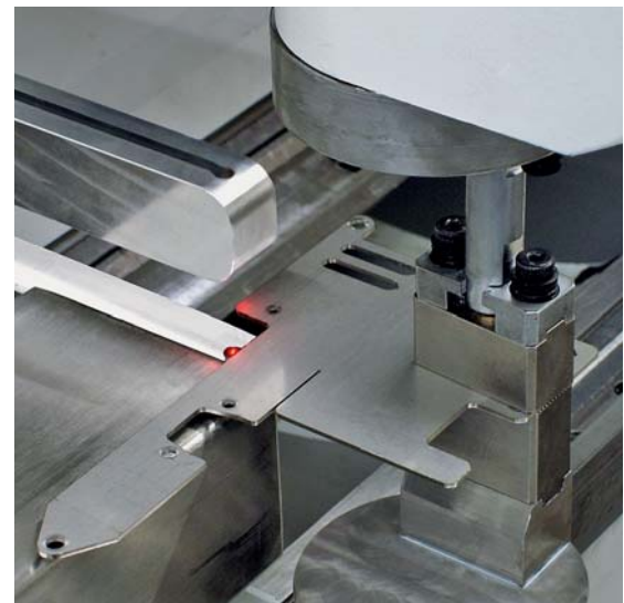
Nachdem drei Punkte der Platine vermessen sind, kennt das System die exakte Aufnahmeposition der Platine und korrigiert auf dem Weg zur ersten Biegestation alle Abweichungen zur theoretischen Greifposition des Manipulators.
