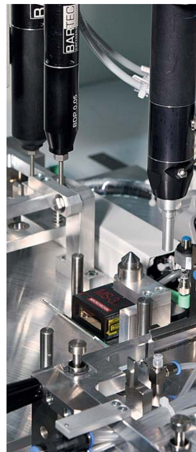
Plasmavorbereitung und zweifache Ein-Komponenten-Dosierung mit Schneckenpumpe zum Vergießen elektrischer Geräte.
