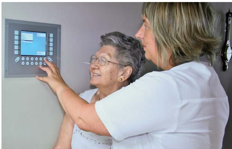
Jedes Zimmer ist mit einem Beckhoff Panel-PC mit Touchscreen ausgestattet. Über einen Identifikationsbutton kann sich der Pfleger für Aufzeichnungen einloggen.
