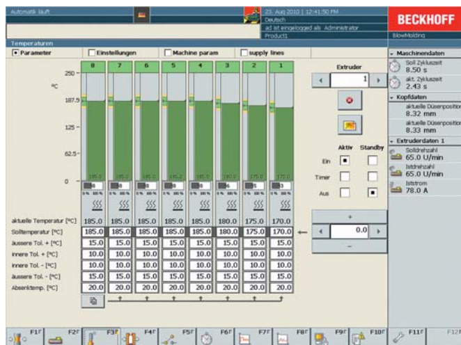
Auf der Bedienoberfläche zur Temperaturregelung sind alle wichtigen Parameter der Regelzonen auf einen Blick zu erkennen; kritische Temperaturabweichungen werden durch Farbumschlag angezeigt.
