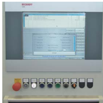
Der Beckhoff Panel-PC C3640 ist mit dem Betriebssystem Windows XP Professional und der Runtime TwinCAT PLC im Einsatz.
