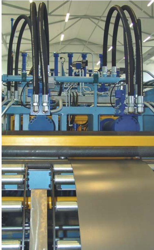
Insgesamt 12 hydraulische Servoachsen erzeugen zwei Mal 250 t Schubkraft zum Falten der Kühlbleche.
