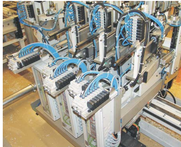
Komplexer Aufbau von Pneumatik-Ventilinseln mit Anschluss an Beckhoff-Busklemmen
