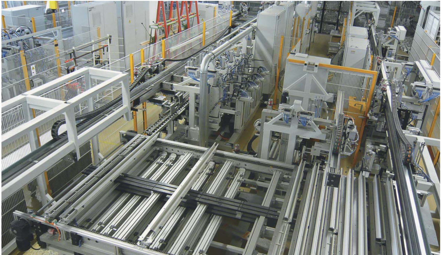
Stabbearbeitungszentrum Typ SBZ II mit Einschubvorrichtung für PVC-Profile bis 3.750 mm Länge und NC-positionierter Greifzange für Positioniergeschwindigkeiten bis 180 m/min
