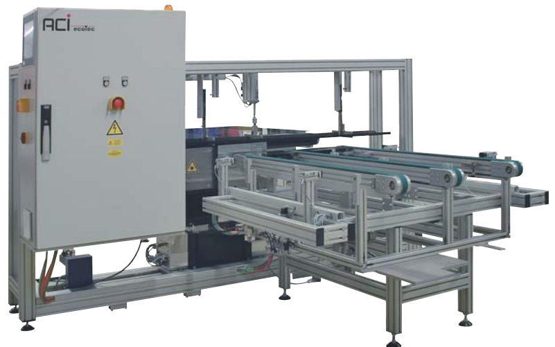
Die Mehrfachmarkierstation, eine der Produktionsinseln innerhalb der Photovoltaik-Prozesskette, wird von einem Beckhoff Embedded-PC CX1020 gesteuert.
