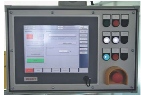
Das 12-Zoll-Panel CP6901 mit Tragarmaufstellung zeigt Anlagenbilder der Aushärtestation ecoCure.
