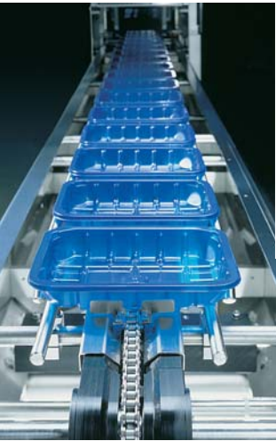
Traysealer verpacken befüllte Schalen, wobei das Befüllen an der Maschine oder räumlich getrennt von ihr erfolgt. Traysealer lassen sich schnell und bequem auf andere Formate umrüsten.
