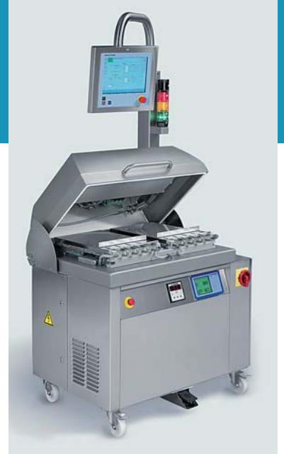
Die Einzel- und Doppelkammermaschinen der TC-Reihe verpacken hochsensible medizinische Artikel unter Vakuum oder Schutzgas in Folienbeutel. Das temperaturgeregelte Siegelsystem ermöglicht die Kontrolle über alle Siegelparameter – eine Voraussetzung für die Validierung.
