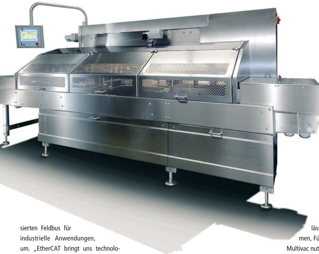
Traysealer verpacken befüllte Schalen, wobei das Befüllen an der Maschine oder räumlich getrennt von ihr erfolgt. Traysealer lassen sich schnell und bequem auf andere Formate umrüsten.
