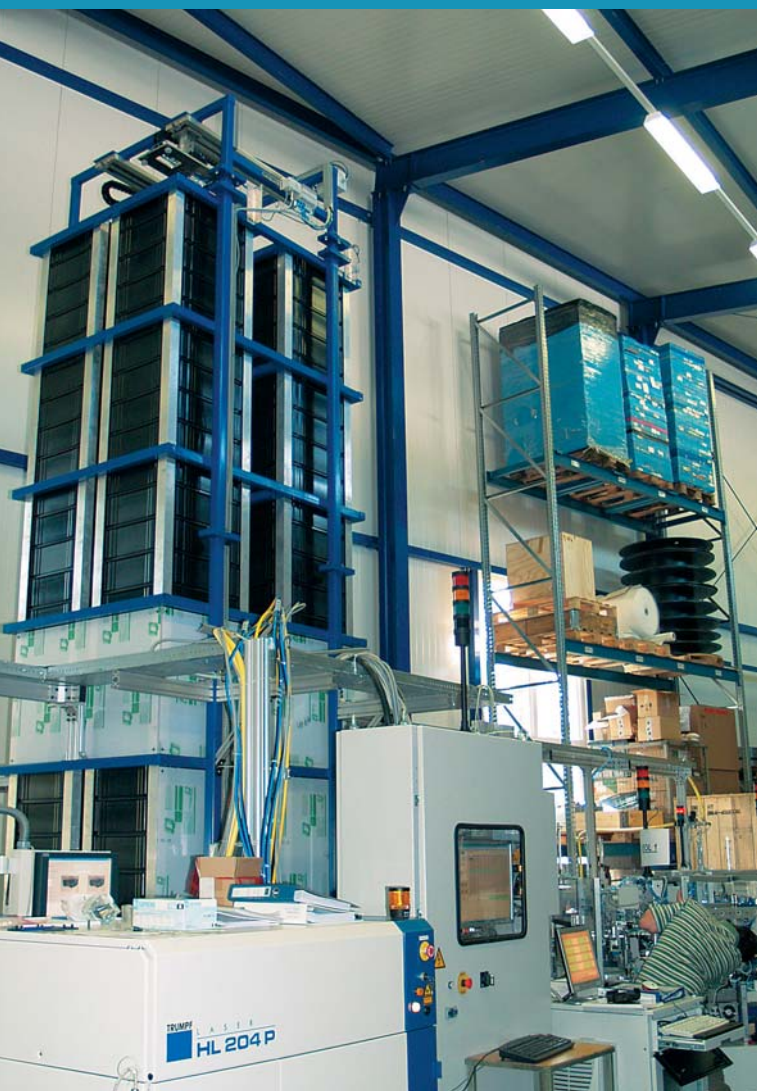
Die neue Produktionsanlage von Pollmann während der Testphase im Werk Karlstein: Im Vordergrund die Laserschweißmaschine des Herstellers Trumpf, im Hintergrund der 4 m hohe Speicherturm, der zur Aushärtung der aus der Zweikomponenten-Vergussstation kommenden Gussteile dient und zugleich als Pufferlager innerhalb des Gesamtproduktionsprozesses genutzt wird.
