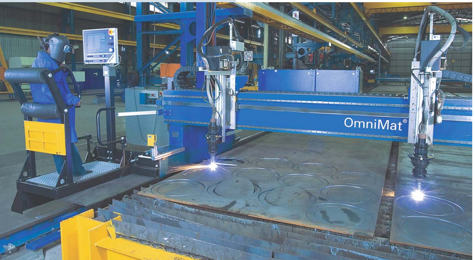
Präzise und schnelle Schnitte laufen dank der „Global Control“ von Messer Cutting & Welding GmbH vollautomatisch ab.
