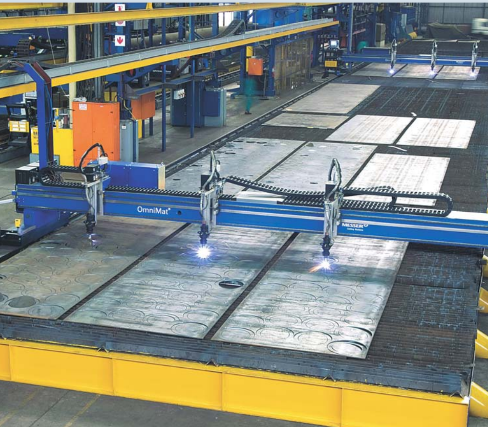
Durch den gleichzeitigen Einsatz von drei HPR260-Plasmaschneidern erzielt Trident Steel hohe Qualität bei hervorragender Produktivität.
