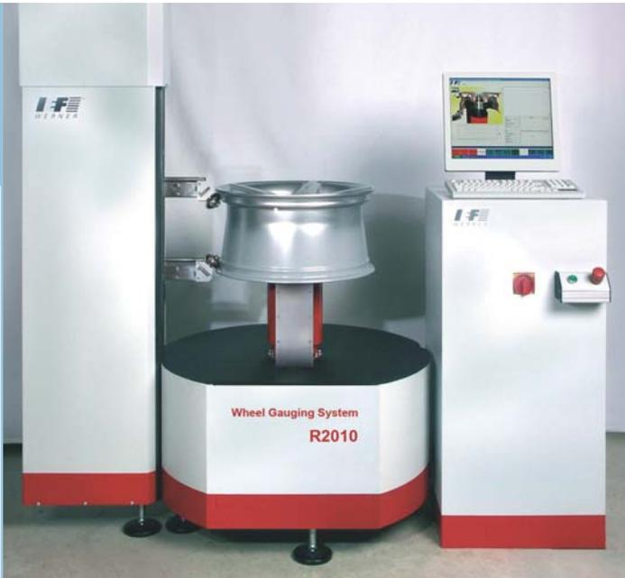
Die Radmessmaschine R2010 für PKW-Räder arbeitet präzise, wiederholgenau und schnell dank moderner, PC-basierter Steuerungstechnik.
