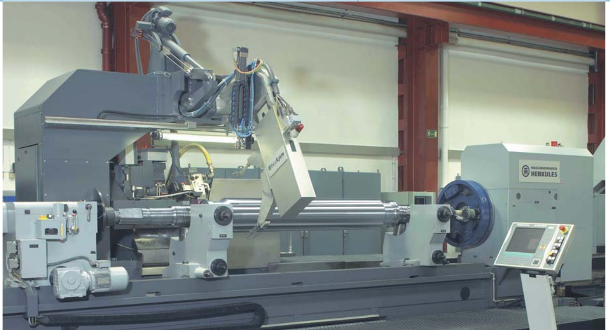
Herkules Walzenschleifmaschine WS 450 Monolith™ zum Schleifen von Arbeits- und Zwischenwalzen
