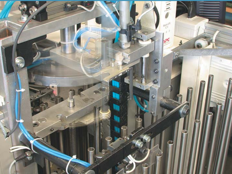
Detail der Maschine, hier Ringausgabebelager der Stäbe der Hauptkette
