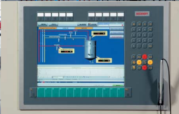
Control Panel, auf dem die Scada-Software mit dem SQL-Prozessbildschirm läuft.
