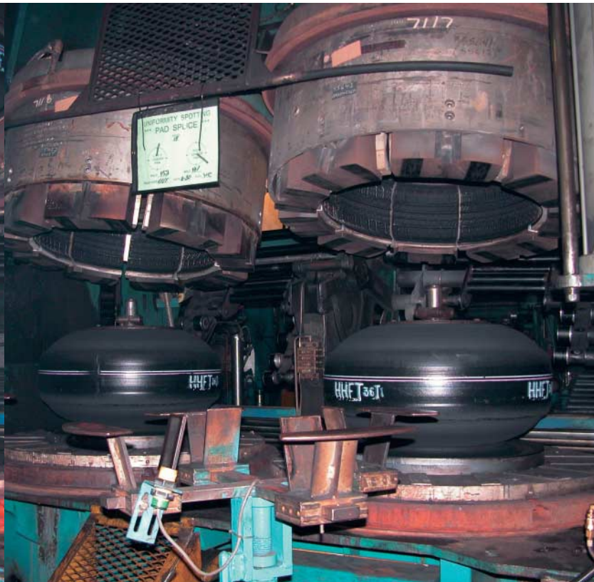
Bei den neuen Segmentformen werden 11 Stahlsegmente eingesetzt, um die Reifenrohlinge zu formen und zusammenschweißen.
