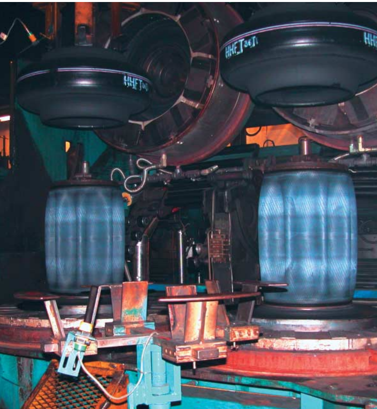
Heizbälge werden in den Reifenrohlingen aufgepumpt, um die richtige Form und Naht zu erhalten.
