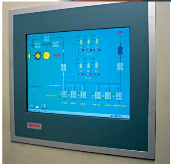
Ausgangspunkt der Maschinenüberarbeitung war die Beseitigung langer Verkabelungen mit Hilfe der PROFIBUS-Technologie mit 1,5 MBit/s. Die Steuerung erfolgt über Beckhoff Industrie-PCs C6130 und CP6502 (Bild oben) sowie Control Panel CP7010.
