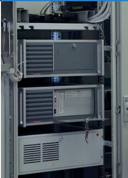
Der 19-Zoll-Einschub-PC von Beckhoff fungiert als Steuerungs-PC, auf dem die Automatisierungssoftware TwinCAT NC I abläuft.
