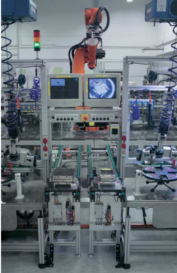
Die Anlage im Gesamten: Die beiden Schweißkammern sind jeweils u. a. mit einem Laser für die Schweißung, einem Kamerasystem und einem Visualisierungs-PC an der Bedieneinheit ausgerüstet. Das Stahlgitter-Handling übernimmt ein Kuka-Roboter.
