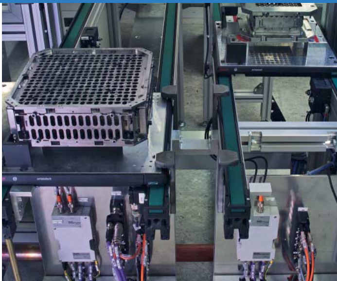
Die Anlage im Gesamten: Die beiden Schweißkammern sind jeweils u. a. mit einem Laser für die Schweißung, einem Kamerasystem und einem Visualisierungs-PC an der Bedieneinheit ausgerüstet. Das Stahlgitter-Handling übernimmt ein Kuka-Roboter.
