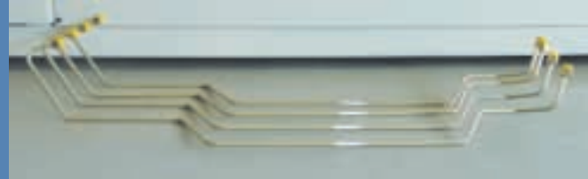
Gebogene Rohrleitungen mit vorgefertigten Rohranschlüssen.
