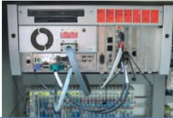
Die Steuerung: Schaltschrank-PC C6240 und Busklemmen mit SERCOS-Koppler.
