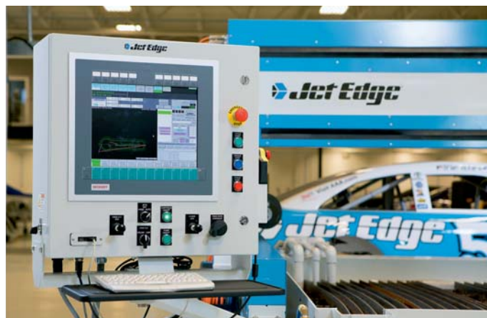
Als Maschinendisplay nutzt Jet Edge das Control Panel CP6912 mit DVI/USB-Erweiterung, das bis zu 50 m entfernt vom Industrie-PC C6920 installiert werden kann.
