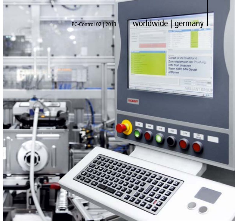
Über das für die Vaillant Group kundenspezifisch entwickelte Control Panel wird der Prüfprozess überwacht.
