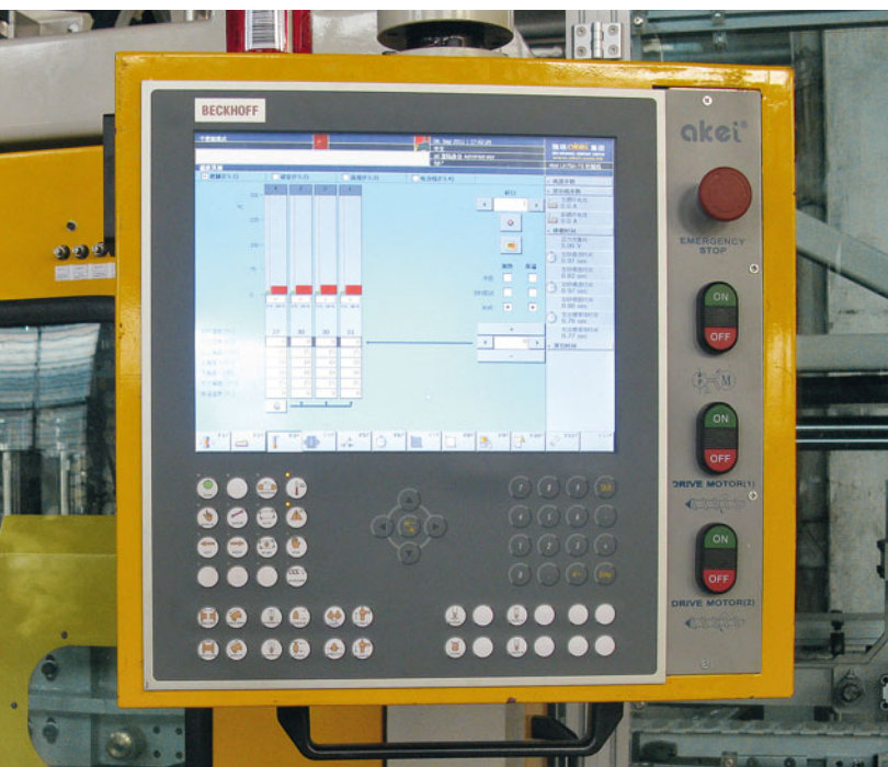
Der Beckhoff Blowmolding-Panel-PC CP6202-1026-0010 stellt alle Funktionen zur Bedienung der Blasformmaschinen zur Verfügung.
