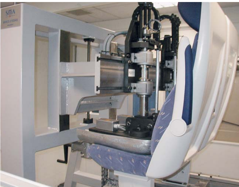
Belastungssimulator zum Test von Sitzen und Prüfanlage für ABS-Bremsystem (v. o. n. u.)
