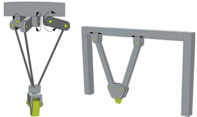
Beispiele für parallele Kinematiken: Delta- und Scheren-Kinematik
